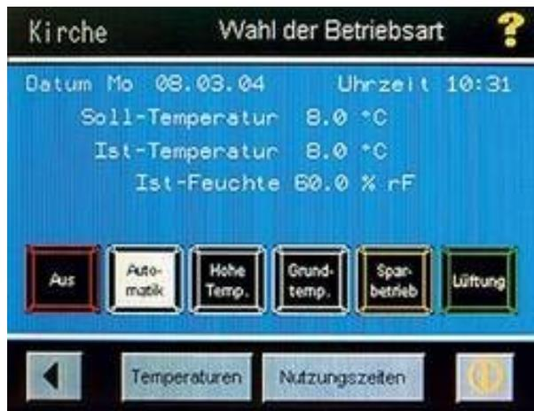
Regeleinrichtungen größerer Art kommen nur bei stationärem Heizbetrieb in Betracht, bzw. bei Warmluftheizung. Die übliche billige Regelung durch Raumthermostate ist wenig sinnvoll, da mit ihnen keine langsame Verschiebung der erwünschten Temperaturbereiche möglich ist. Es muss deshalb eine elektronische Regelung eingeplant
