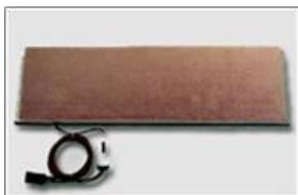
und Kondensation. Durch die geringe Masse besteht auch eine niedrige Wärmeträgheit. Der im Sitzpolster integrierte Flächenheizleiter ist ein Glasfasergewebe, das mit elektrisch leitendem Kunststoff „PTFE-Carbon“ beschichtet ist. Der Heizleiter ist vollisoliert, somit ist kein Schutzleiter erforderlich. Der Vorteil
