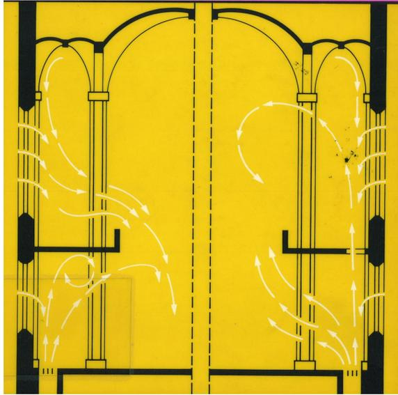
Im Bereich von Emporen sind Wärmestaus unterhalb dieser und vermehrte Zuglufterscheinungen oberhalb der Emporen keine Seltenheit. Die hierbei entstehenden unterschiedlichen Temperaturverläufe sorgen nicht nur für ein unangenehmes Wohlbefinden, sie können auch Bauschäden durch Tauwasseranfall oder Verformungsschäden (siehe Kapitel 1 Seite 5), zu Rissen im Holz oder zu abbröckelnder Farbe führen.
